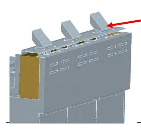
STEP 3: INSTALL THE FLUE DEFLECTORS (8239025) AS SHOWN.
